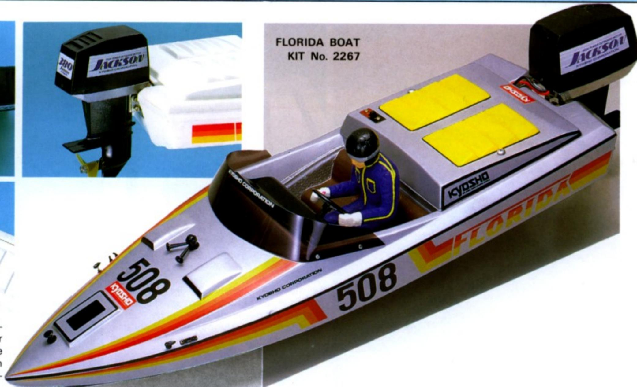
La batterie peut être remplacée instantanément. Avec deux batteries et un chargeur rapide, il est possible de naviguer de manière presque continue. Le hors bord Jackson contient le puissant moteur MABUCHI RS-380S avec transmission sur l'hélice.
