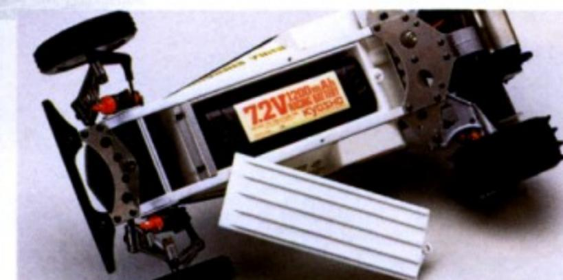
LES QUATRE AMORTISSEURS DE 10mm SONT DU TYPE HYDRAULIQUE
