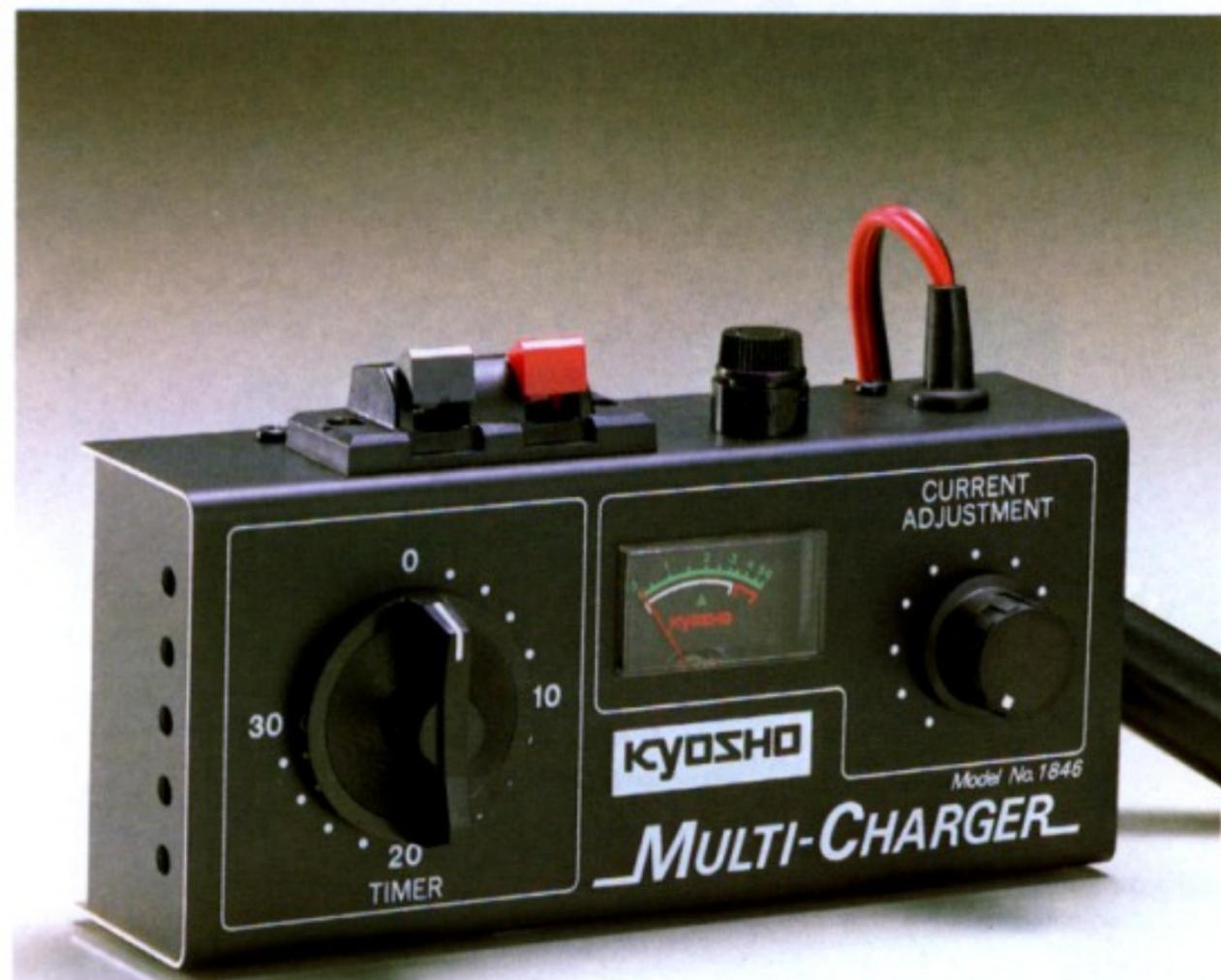
Charge les batteries Ni-Cad de 6 à 7,2 V et de 425 à 4000 mA, avec minuterie et réglage du courant de charge.
