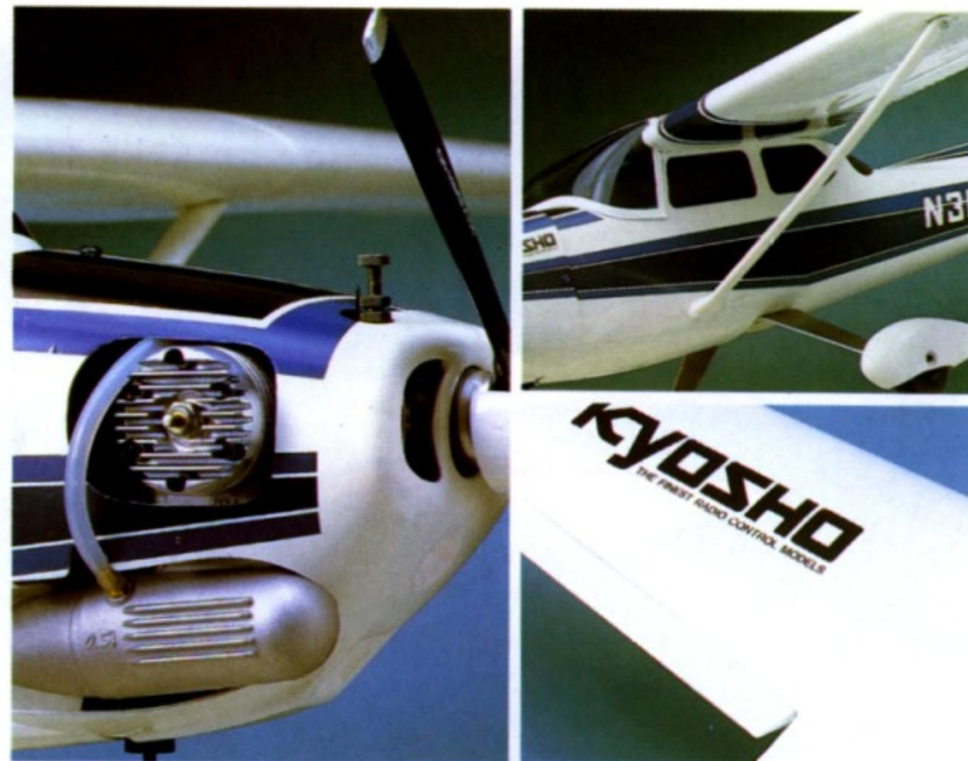
Le moteur est monté sur le côté donnant ainsi une belle allure de maquette au CESSNA, et facilitant son entretien. Les commandes d'ailerons intégrées dans les ailes en usine facilitent l'assemblage. Haubans et carénages de roues améliorent le réalisme.
